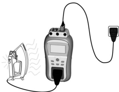
Obrázek: Měření diferenčního unikajícího proudu
