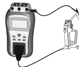
Obrázek: Měření kontinuity uzemnění
