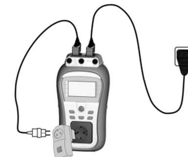
c) Test PRCD přes testovací zásuvku
