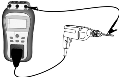
Obrázek: Měření izolačního odporu - P
