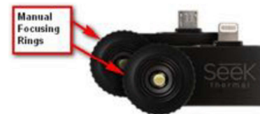
Obr. 19: Zaostřovací kolečko pro manuální zaostření
