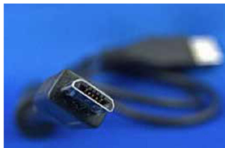
Obrázek 49: Samice micro-B na USB kabelu
