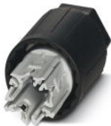
Matice QUICKON, černá, 4+PEpólová, 1,0 mm 2 ... 2,5 mm 2 / 690 V / 20 A, pro vodiče s průměrem 6 mm ... 11 mm.
