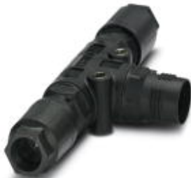
Rozvodka T QUICKON, černá, 4+PEpólová, 1,0 mm 2 ... 2,5 mm 2 / 690 V / 20 A, pro průměr kabelu 9 mm ... 16 mm, se dvěma maticemi Quickon
