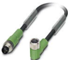
Kabel pro snímače / akční členy, 3-pólový, PUR bezhalogenové, černošedá RAL 7021, Zástrčka přímo M8, na Zásuvka úhlový M8, Délka kabelu: 0,3 m
