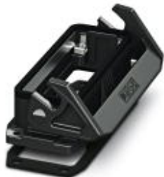
Montážní kryt HEAVYCON EVO z plastu, B24, s podélným zámkem, výška 30,5 mm, s plochým těsněním
