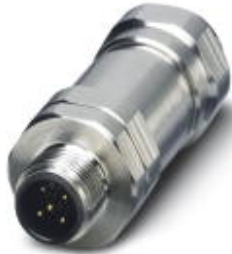
Konektory, 5-pólový, stíněná, Zástrčka přímo M12, kódování A, Šroubové připojení, Rýhovaný materiál: Ušlechtilá ocel, Kabelové šroubení M16, Vnější průměr kabelu 5,5 mm ... 8,6 mm
