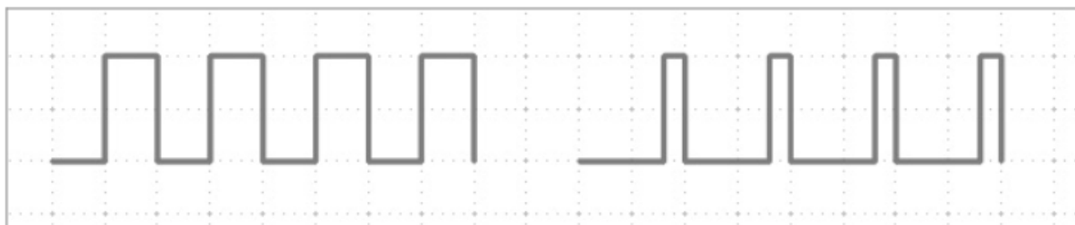
Slika 6.1: Levo: delovni cikel 50 % – desno: delovni cikel 20 %.
