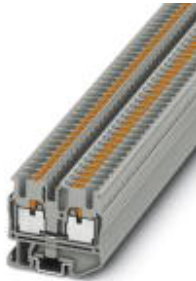
Průchozí miniaturní svornice, Způsob připojení: Svorky Push-in, Počet přípojek: 2, Průřez: 0,14 mm 2 - 4 mm 2 , AWG: 26 - 12, Šířka: 5,2 mm, Výška: 32,1 mm, Barva: šedá, Způsob montáže: NS 15
