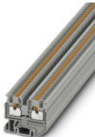
Průchozí miniaturní svornice, Způsob připojení: Svorky Push-in, Počet přípojek: 2, Průřez: 0,14 mm 2 - 1,5 mm 2 , AWG: 26 - 14, Šířka: 3,5 mm, Barva: modrá, Způsob montáže: NS 15
