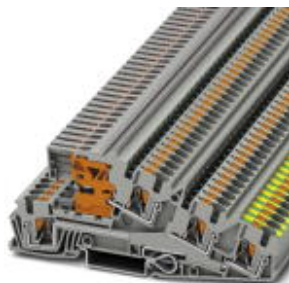
Instalační svornice ochranného vodiče, Svorky Push-in, Průřez: 0,2 mm 2 - 6 mm 2 , AWG: 24 - 10, Šířka: 6,2 mm, Barva: šedá, Způsob montáže: NS 35/7,5, NS 35/15
