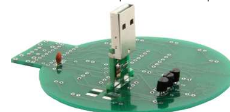
Poloha USB konektoru pro vertikální USB port
