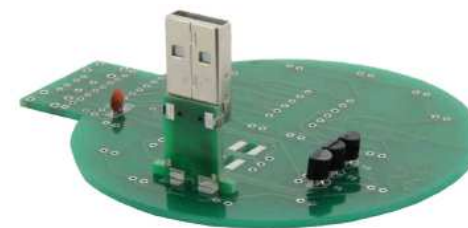
Poloha USB konektoru pro horizontální USB port
