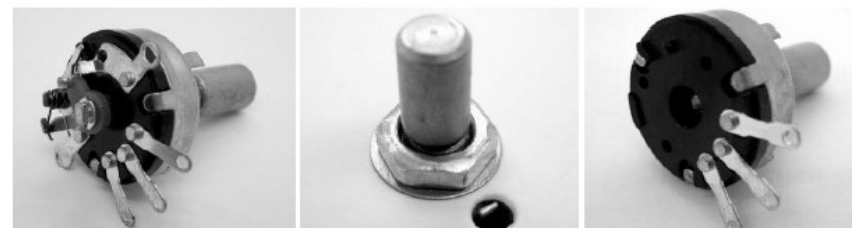
Regulátor hlasitosti a zpětnovazební člen (potenciometr).
