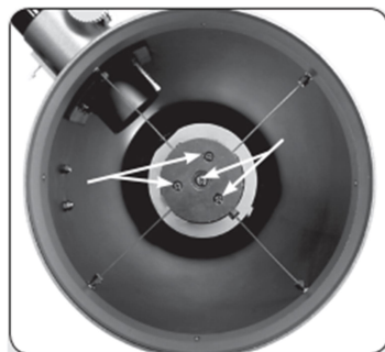
Obr. 31b: Čtyři kolimační šrouby na krytu sekundárního zrcátka
