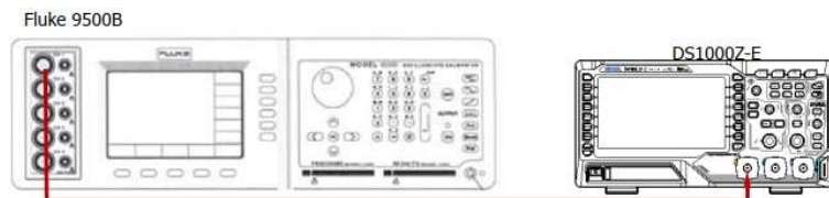
Obr. 2-4: Připojovací schéma testu omezení šířky pásma
