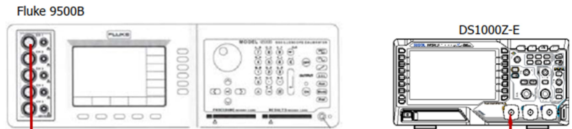
Obr. 2-1: Připojovací schéma testu impedance
