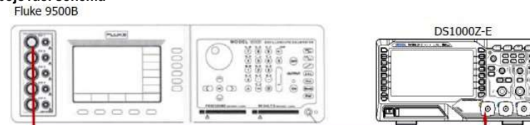
Obr. 2-5: Připojovací schéma testu přesnosti časové základny
