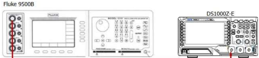
Obr. 2-2: Připojovací schéma testu DC zisku
