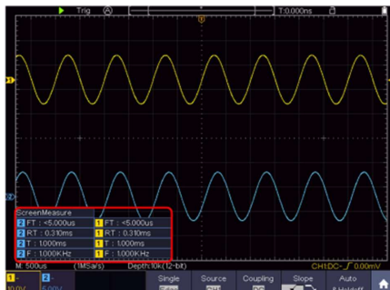
Obrázek 7 – 1: Měření hodnoty periody a frekvence signálu
