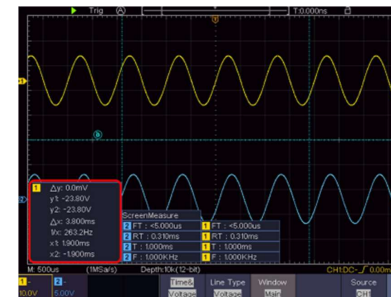
Obrázek 4 – 20: Kurzorové měření času a napětí
