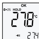
Obrázek 6.6: Zobrazení hodnoty naměřené termočlánkem
