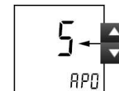
Obrázek 8.7: Nastavení automatického vypnutí (APO)
