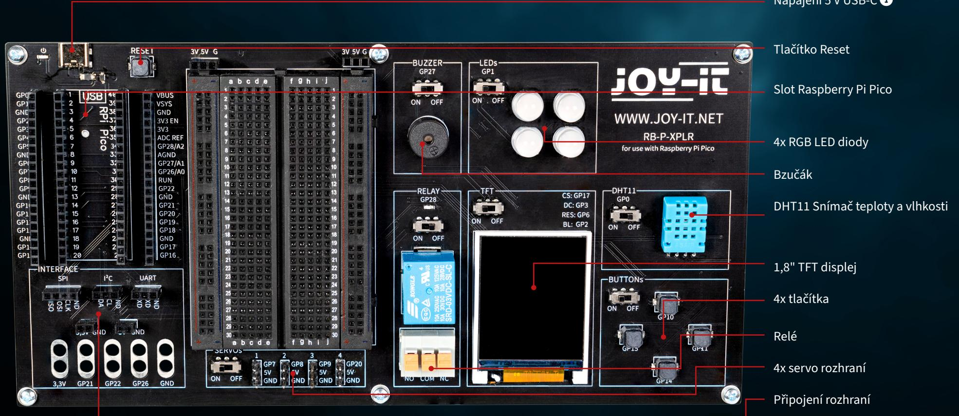
💡 Vezměte prosím na vědomí, že připojení USB-C musí být vždy připojeno, aby bylo možné jej používat. Napájení přes připojení micro USB počítače Raspberry Pi Pico není možné.
