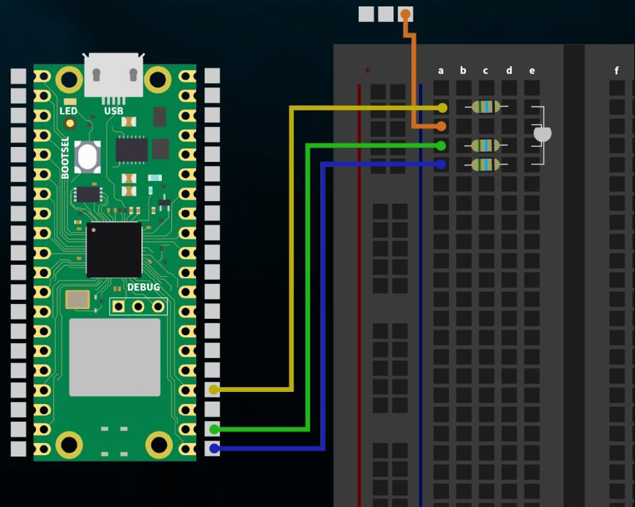
**SHRNUTÍ:** Tři barevné kanály RGB LED (červená, zelená a modrá) se zapínají a vypínají pomocí tlačítek (vlevo, nahoře a vpravo).
