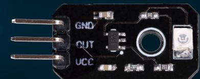
Jádro snímače obsahuje materiál, který reaguje na UV záření. Když UV paprsky na tento materiál dopadnou, senzor změní svůj elektrický odpor. Tuto změnu senzor převede na signál, který můžeme změřit a odečíst. Pomocí počítače Raspberry Pi Pico pak můžeme tento signál převést na hodnotu, která udává, jak silné je aktuálně UV záření.
