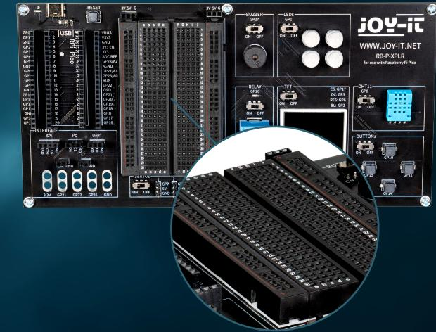
**Hlavní oblasti:** Ty se skládají z řady rovnoběžných řad otvorů, obvykle oddělených středovou drážkou. Otvory v jedné řadě jsou vzájemně elektricky propojeny. Toto uspořádání je ideální pro vkládání integrovaných obvodů (IC) a dalších součástek.
