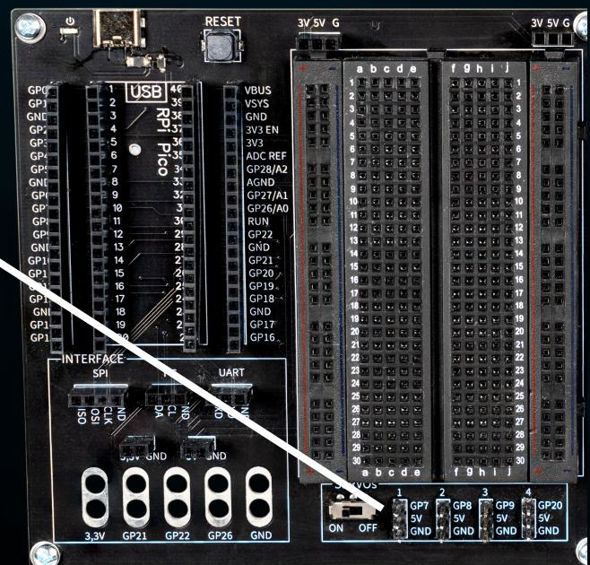
**POZOR!** Pro tento projekt je nutné nastavit přepínač pro TFT displej, tlačítka a serva na ON.
