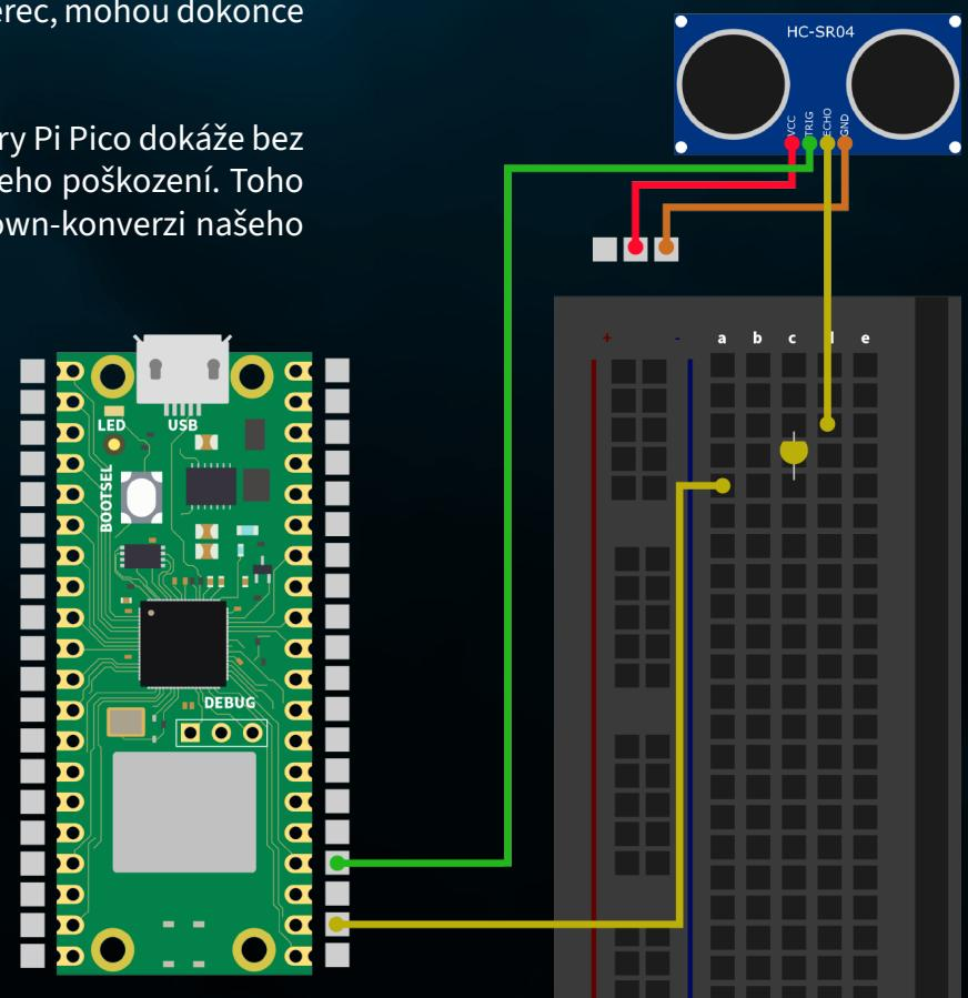
**SHRNUTÍ:** V našem prvním projektu měříme vzdálenost pomocí ultrazvukového senzoru a naměřenou vzdálenost vizualizujeme pomocí většího či menšího vyplnění grafiky na TFT displeji. V našem příkladu zcela vyplníme displej z naměřené vzdálenosti 100 cm.
