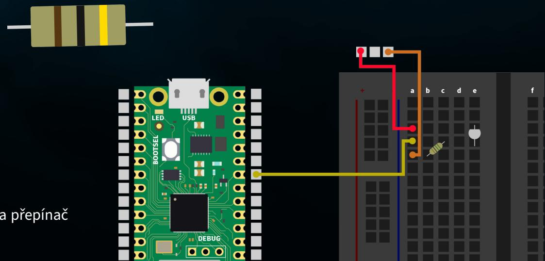
**POZOR!** Pro tento projekt je nutné nastavit přepínač pro relé na OFF a přepínač pro LED diody na ON.
