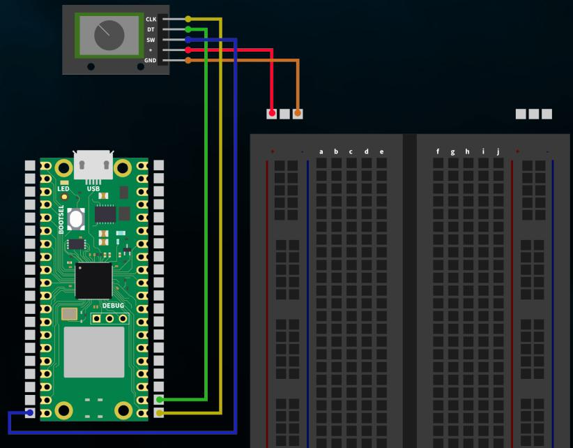
**SHRNUTÍ:** K ovládání barvy a jasu našich čtyř diod LED používáme otočný snímač. Otáčením enkodéru měníme jas, zatímco stisknutím enkodéru nastavujeme barvu diod LED.
