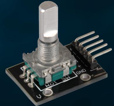
**SHRNUTÍ:** Otočný snímač umožňuje posílat různé příkazy projektům elektroniky otáčením a stisknutím. Jedná se o intuitivní a všeobecný nástroj, díky kterému je interakce s vašimi projekty snadná a zábavná.
