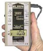
... den Klinkenstecker des beiliegenden Erdungskabels in die dafür vorgesehene Buchse  $\perp$  stecken und das Kabel an der Seite des Gehäuses nach hinten führen. Erdungskabel oder Finger dürfen nicht über die Vorderkante des Messgeräts hinausragen (verfälscht den Messwert!).
