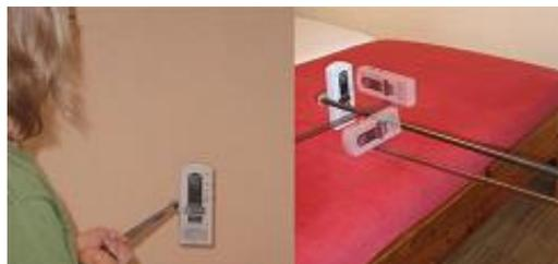
Methode allerdings viel Know-how, die Verwendung eines nicht leitfähigen Halters (z.B. die PM-Serie von Gigahertz Solutions), drei Messungen in den drei Raumachsen XYZ (gem. Abb.) und die
