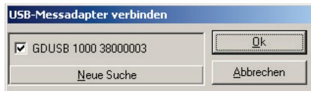
Falls kein Gerät gefunden wurde, klicken Sie auf "Neue Suche". Der USB-Port wird initialisiert und angeschlossene Geräte erkannt. Sollte dennoch kein Messadapter gefunden werden, überprüfen Sie bitte nochmals folgende Punkte:
