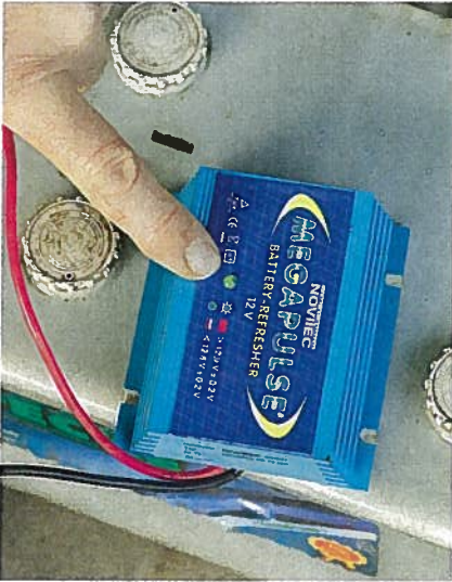
Wenn die grüne Diode leuchtet, arbeitet der Pulser. Sinkt die Batteriespannung unter 12,9 Volt, schaltet er zum Schutz der Batterie automatisch ab.
