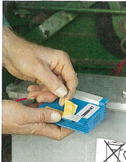
Man könnte den Pulser mit kleinen Schraubchen befestigen. Eigentlich reicht es aber aus, wenn man ihn mit doppelseitigem Klebeband auf die Batterie klebt.
