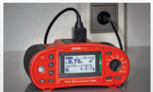
IT 115 bei der Schleifenimpedanzmessung ohne RCD-Auslösung
