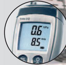
Gleichzeitige Anzeige von Strömungs- und Druckwert
