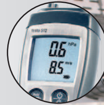
Gleichzeitige Anzeige von Strömungs- und Druckwert
