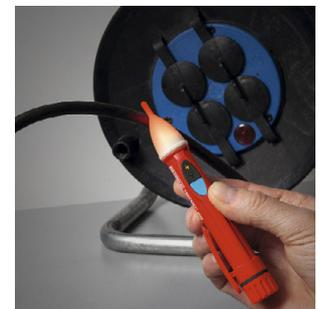
Prüfung auf Kabelbruch
