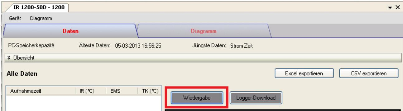
Im Echtzeitmodus wird mit der Übertragung von Daten an den Computer begonnen, wenn der Schalter am Gerät gedrückt wird. Wenn der Schalter nicht gedrückt ist, werden keine Daten übertragen.
