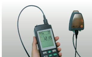
Überprüfung von Messwert-Umformern mit 4...20 mA-Interface
