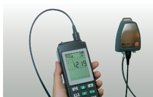
Überprüfung von Messwert-Umformern mit 4...20 mA-Interface
