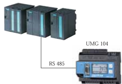
Beispiel SPS Kommunikation mit Profibus oder Modbus
