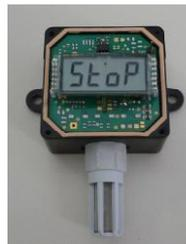
12. Montieren Sie den Deckel wieder auf dem Gehäuse.
