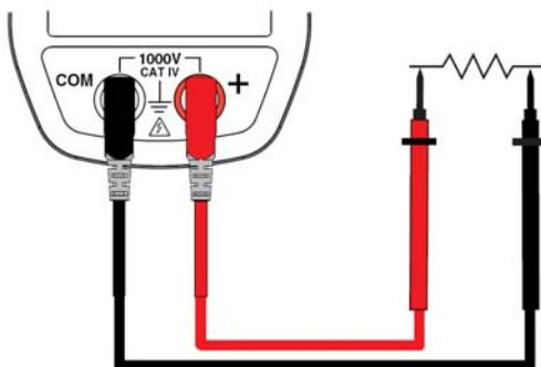
Besteht Durchgang, d.h. der Widerstand ist kleiner als die eingestellte Schwelle, ertönt ein Signal und der Messwert erscheint in der Digitalanzeige.
