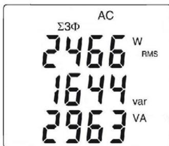
**Hinweis:** Sie können die gesamte Drehstromleistung auch an einem symmetrischen 4-Leiter-Drehstromnetz wie oben beschrieben messen, oder die Leistung wie an einem Einphasennetz an nur einem Phasenleiter messen und den gemessenen Wert mit drei multiplizieren.
