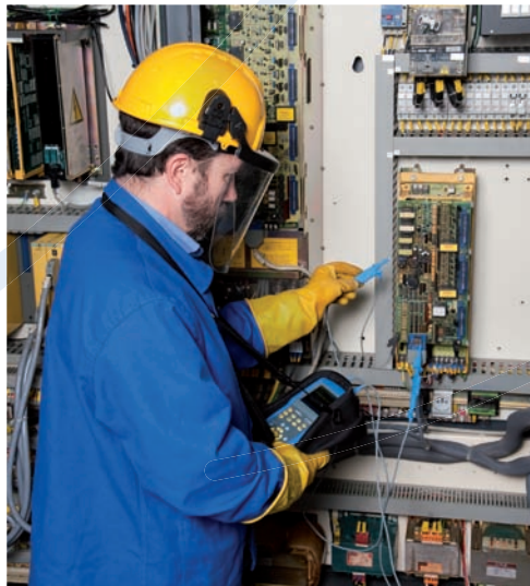
Funktionsprüfung an der elektronischen Steuerung einer Werkzeugmaschine
