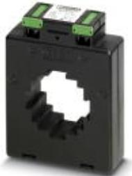
Aufsteckstromwandler, Primärstrom 200 A AC; Sekundärstrom 5 A AC; Genauigkeitsklasse 1; Bemessungsleistung 5 VA
