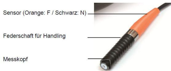
Der Sensor ist am unteren Schaftsegment anzufassen und wird nur leicht auf das Prüfbjekt angedrückt. Das schwarze, geriffelte Schaftsegment ist auf einer Feder beweglich gelagert. Durch die Feder drückt der Sensorkopf mit einer definierten Kraft auf das Prüfbjekt und vermeidet dadurch Messfehler.
