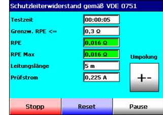
Durch Tastenbetätigung <+> wird umgepolt gemessen. Beendigung oder Abbruch der Messung durch Taste <Stopp>, Messpause durch Taste <Pause>/ <Weiter>, Löschen des Messwertes durch Taste <Reset>.
