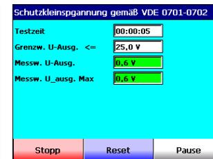
Messbeginn durch Betätigen der Taste <Start>. Mit der Sonde ist die PELV/ SELV Spannung abzutasten.
