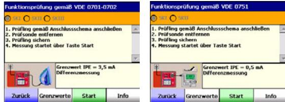
Es werden die Grenzwerte nach VDE 0701-0702 oder nach VDE 0751-1 berücksichtigt. Durch Tastenbetätigung <L-N> wird umgepolt gemessen. Beendigung oder Abbruch der Messung durch Taste <Stopp>, Messpause durch Taste <Pause>/<Weiter>, Löschen des Messwertes Taste <Reset>.
