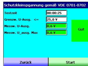
Neben dem Messergebnis (Messwert) wird das Gesamtergebnis z.B. „Gut“ durch ein grün hinterlegtes Feld und „Schlecht“ durch rot hinterlegtes Feld angezeigt.
