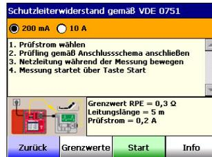
Der Prüfstrom 200mA oder 10A ist einstellbar. Es werden die Grenzwerte nach VDE 0701-0702 oder nach VDE 0751-1 berücksichtigt.
