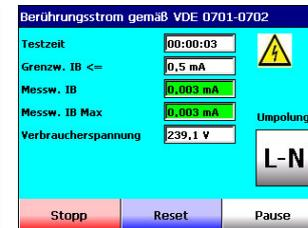
Es werden die Grenzwerte nach VDE 0701-0702 berücksichtigt. Durch Tastenbetätigung <L-N> wird umgepolt gemessen. Beendigung oder Abbruch der Messung durch Taste <Stopp>, Messpause durch Taste <Pause>/<Weiter>, Löschen des Messwertes durch Taste <Reset>.
