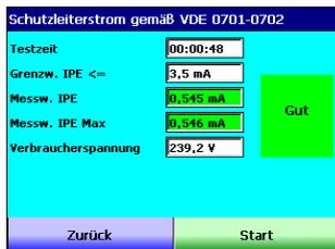
Neben dem Messergebnis (Messwert) wird das Gesamtergebnis z.B. „Gut“ durch ein grün hinterlegtes Feld und „Schlecht“ durch rot hinterlegtes Feld angezeigt.
