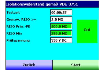
Neben dem Messergebnis (Messwert) wird das Gesamtergebnis z.B. „Gut“ durch ein grün hinterlegtes Feld und „Schlecht“ durch rot hinterlegtes Feld angezeigt.
