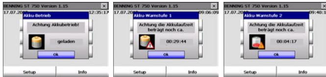
Sobald der Hinweis „Akku-Warnstufe 2“ im Display eingeblendet wird, verbinden Sie bitte umgehend das Gerät mit der Netzspannung um den Akku zu laden. Die Ladung des Akkus erfolgt automatisch im Netzbetrieb bei eingeschaltetem Gerät.
