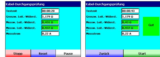
Beendigung oder Abbruch der Messung durch Taste „Stopp“, Messpause durch Taste <Pause>/ <Weiter>, Löschen des Messwertes durch Taste „Reset“. Neben dem Messergebnis (Messwert) wird das Gesamtergebnis z.B. „Gut“ durch ein grün hinterlegtes Feld und „Schlecht“ durch rot hinterlegtes Feld angezeigt.
