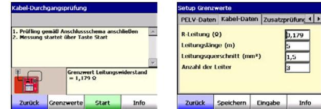
Danach Taste <Grenzwerte> betätigen. Die Parameter Leitungslänge, Leitungsquerschnitt und die Anzahl der Leiter unter <Setup Grenzwerte> / <Kabel-Daten> eingeben.
