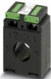
Rohrstabstromwandler, Primärstrom 200 A AC; Sekundärstrom 5 A AC; Genauigkeitsklasse 1; Bemessungsleistung 5 VA
