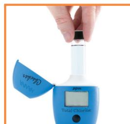
Wasserprobe entnehmen und Küvette in den Checker® einsetzen.
