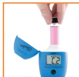
Küvette in den Checker® einsetzen.
