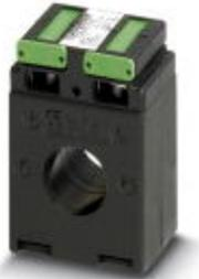
Rohrstabstromwandler, Primärstrom 400 A AC; Sekundärstrom 5 A AC; Genauigkeitsklasse 1; Bemessungsleistung 5 VA
