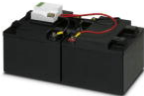
Energiespeicher, Blei-AGM, VRLA-Technologie 24 V DC, 26 Ah, werkzeugloser Batteriewechsel, automatische Erkennung und Kommunikation mit der QUINT UPS-IQ
