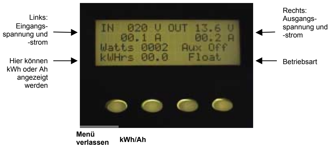
Bild 6 - MX60 Betriebsanzeige (STATUS)
