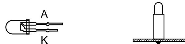
Fehlt eine eindeutige Kennzeichnung einer LED oder sind Sie sich mit der Polarität in Zweifel (da manche Hersteller unterschiedliche Kennzeichnungsmerkmale benutzen), so kann diese auch durch Probieren ermittelt werden. Dazu gehen Sie wie folgt vor:
