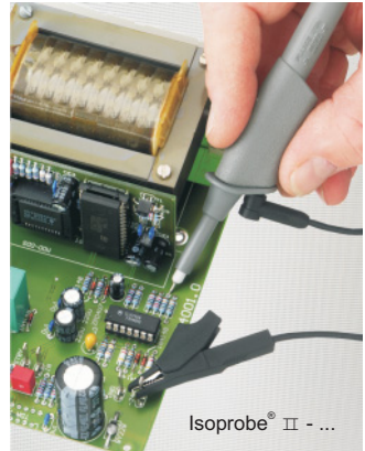
Passiver Tastkopf, hohe Eingangskapazität
