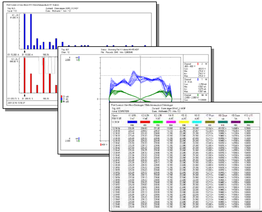
Abb. 3.5.2-d: Bildschirm drucken der Darstellungsarten FFT-Balken, X-Y-Schreiber, Datenlogger
