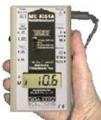
... den Klinkenstecker des beiliegenden Erdungskabels in die dafür vorgesehene Buchse  $\perp$  stecken und das Kabel an der Seite des Gehäuses nach hinten führen. Erdungskabel oder Finger dürfen nicht über die Vorderkante des Messgeräts hinausragen (verfälscht den Messwert!).
