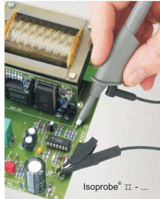
Passiver Tastkopf, hohe Eingangskapazität
