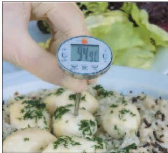
Die schnelle Stichproben-Temperaturmessung mit dem wasserdichten Mini-Thermometer ist im Lebensmittelbereich ein wichtiges Thema. Durch das große, gut ablesbare Display ist eine Temperaturkontrolle auch unter schlechten Lichtverhältnissen gut möglich. Die Hold-Funktion friert den aktuellen Displaywert ein. So können die Anwender den Messwert sicher notieren.
