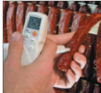
Ein robustes Lebensmittel-Einstech-pH/°C-Messgerät mit automatischer Temperaturkompensation. Die robuste Einstech-Messspitze ist austauschbar und Dank des Loch-Diaphragmas verschmutzungsunempfindlich.
