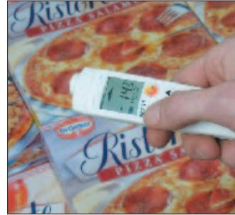
Schnelle berührungslose Messung und Kerntemperatur-Messung in einem Gerät! Mit der Infrarotseite wird die Oberflächen-Temperatur erfasst, mit der Messspitze auf der Einstechseite zusätzlich die Kerntemperatur.
