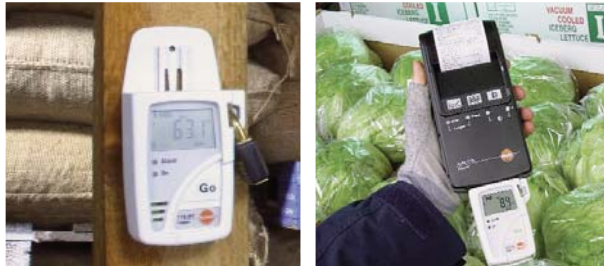
Abb. 7: Einsatz von Datenloggern
