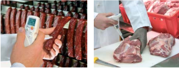
Abb. 9: pH-Wertmessung an Fleisch- und Wurstwaren
