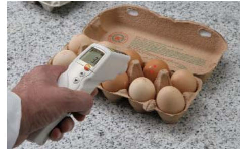
Abb. 5: Infrarot-Messung der Oberflächentemperatur an Nahrungsmitteln
