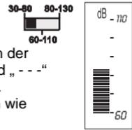
Anmerkung: Wenn der Bereich geändert wird, kann die maximale Anzeige eine Überlastung „OL“ anzeigen. Betätigen Sie die Taste MAX RESET, um die MAX-Anzeige zu löschen.
