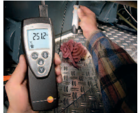
Temperaturmessung in zähplastischem Material mit superschnellem Einstechfühler, ideal für Kunststoff, Lebensmittel, usw.
